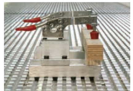
Befestigung von Sonderspannmitteln Der Aluminiumrastertisch mit Schwabenschwanzführungen gewährleistet die präzise formschlüssige Spannelementfixierung
