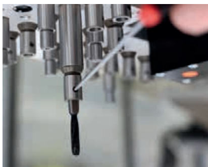
Weldon Wechselsystem für einen Bohrerwechsel mit Werkzeugen
