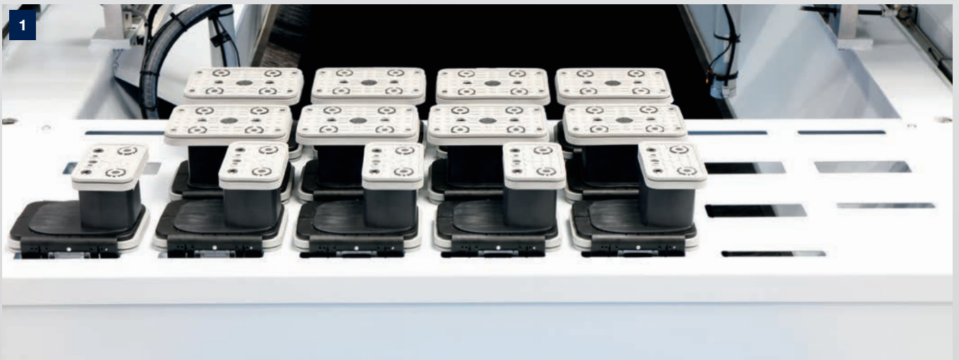
Saugerablageplatz Seitlich in die Maschine integrierter Ablageplatz für Vakuumsauger zum einfachen und schnellen Zugriff
