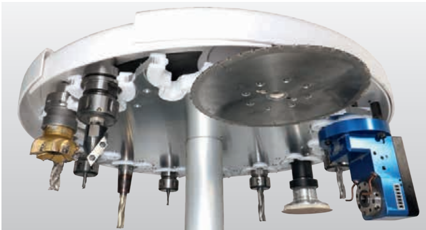
14-fach Tellerwechsler in X-Richtung, mitfahrend
