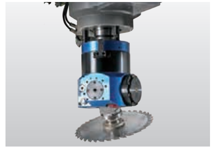
Erweiterung auf FLEX5 (für 4-Achs-Variante) Bestehend aus FLEX5-Schnittstelle und FLEX5-Aggregat
