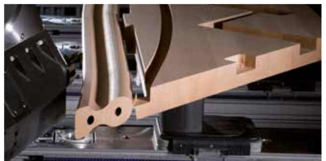
Perçage de trous dans un angle étroit
