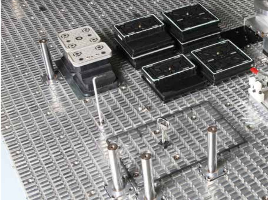
Serrage par le vide : éléments de serrage par le vide pour une utilisation dans les rainures de la table rainurée.
