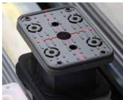
Aide au positionnement à laser (en option) : les ventouses sont indiquées avec un laser à réticule. Le contour des pièces peut être « parcouru » pour aider au positionnement des pièces à formes libres.
