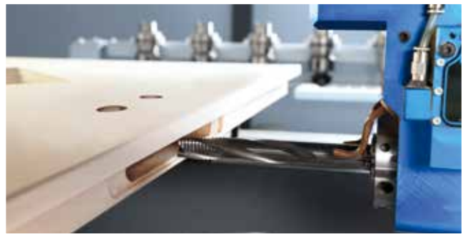
Fraisage de boîtier de serrure
