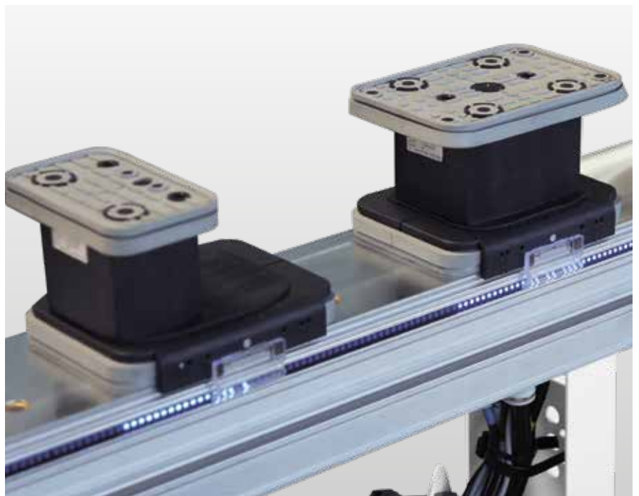
Système de positionnement à LED (en option) : les LED indiquent à l'opérateur exactement la position, l'orientation et la taille des ventouses ainsi que la position des consoles → positionnement jusqu'à 70 % plus rapide
