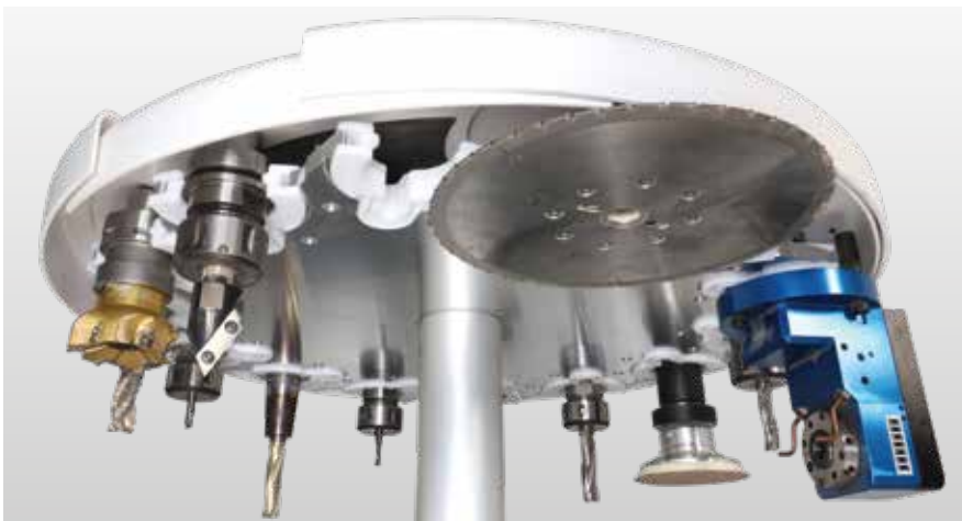
Changeur d'outils à plateau à 14 positions en X, embarqué
