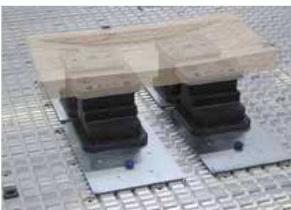
Système Maxi-Flex : panneau système à équiper librement pour le système de serrage par le vide.
