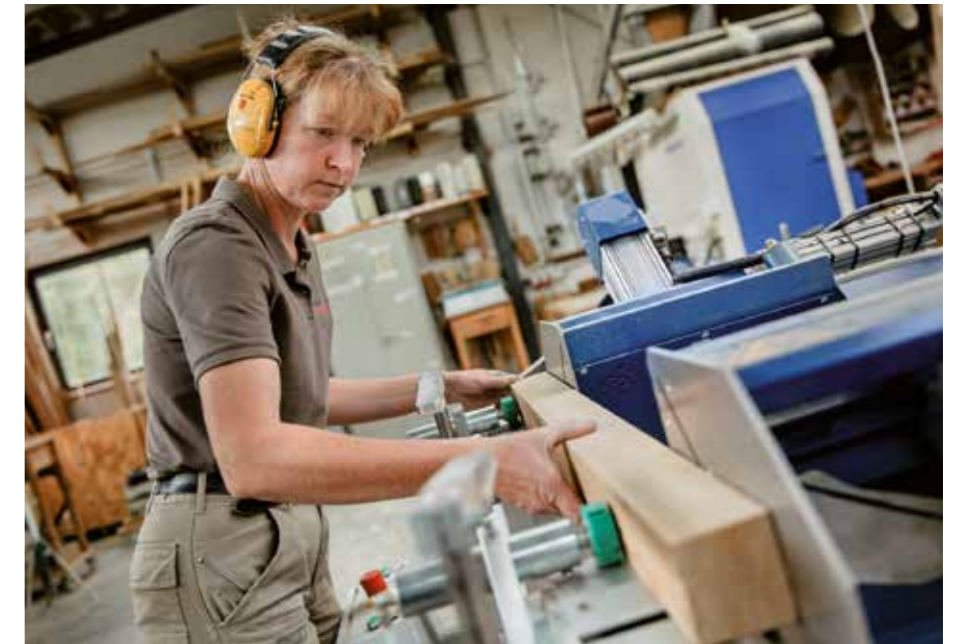
Längen von Profilen und Leisten bis 3.000 Millimeter schneidet die Tischlerei Vielstädte als Standard auf der neuen „Exenso DS“. Teillängen über 3.000 Millimeter werden mit der Überlängenaomatik der Hecht-Software gesteuert und geschnitten
