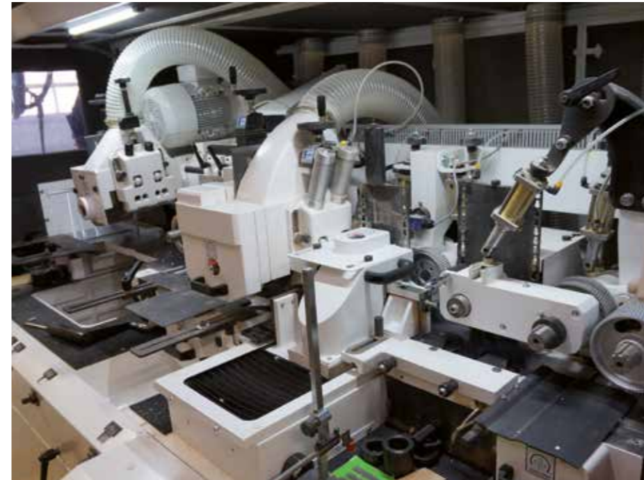
Die neue Vierseitenhobelmaschine von HOMAG mit Profilerwelle von innen
