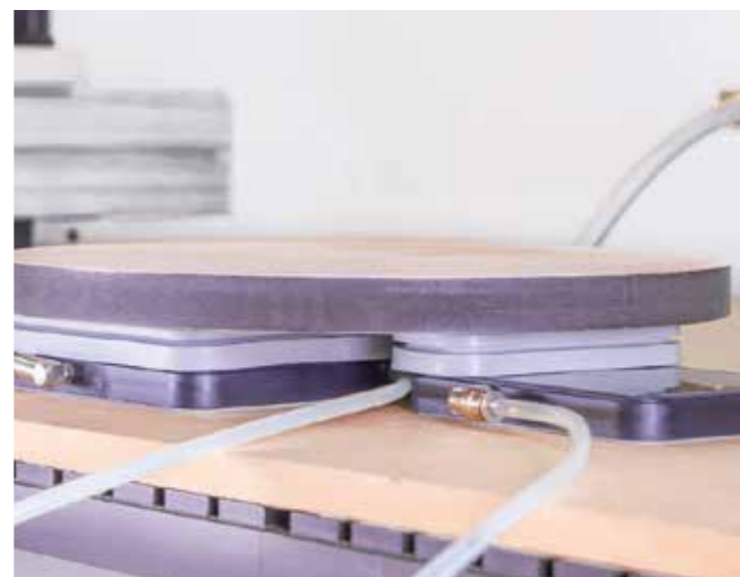
Die Blocksauger VCBL-G K1 können direkt auf der Verschleissplatte der Maschine platziert werden.
