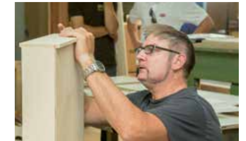
Verleimen ohne Schraubzwingen oder Pressen
